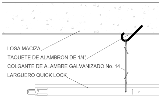
Sistema de fijación con taquete de alambón de 1/4".
